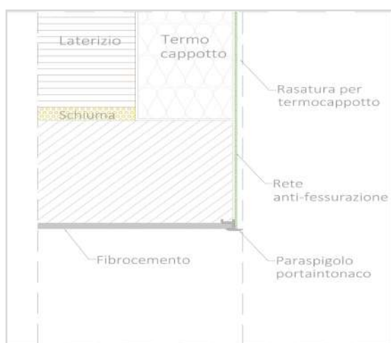
Foto 11. Schema applicazione rete anti-fessurazione
